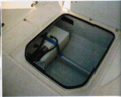
Le plancher du cockpit renferme un coffre où est logé le réservoir de carburant. Il reste aussi de l'espace.
